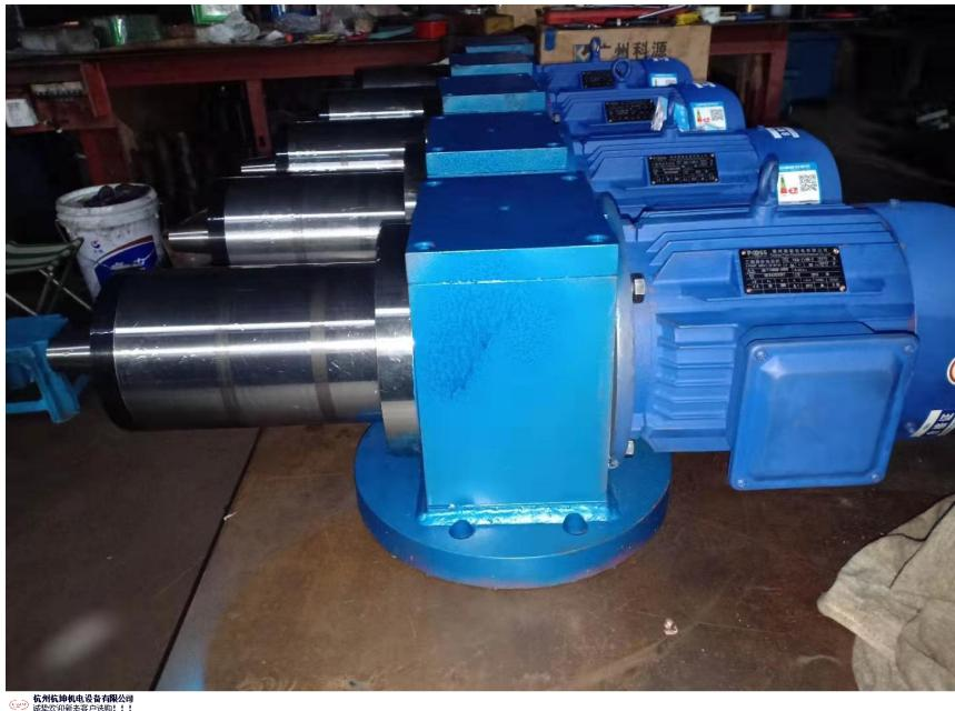
为了适应主轴转速向更高速化发展的需要，新的润滑冷却方式被相继开发出来！这些新的润滑冷却方式不只要减少轴承温升，还要减少轴承内外圈的温差，以保证主轴热变形小！1) 油气润滑方式！这种润滑方式近似于油雾润滑方式，所不同的是，油气润滑是定时、定量地把油雾送进轴承空隙中，这样既实现了油雾润滑，又不至于使油雾太多而污染周围空气；油雾润滑则是连续供给油雾！ 杭州杭坤以客户为中心，为您呈现我们质量的服务！ 杭州杭坤机电设备有限公司成立于2008年，占地2000平方，是一家专业从事液压产品的研发生产与销售的公司。杭坤机电拥有完整的管理体系，公司主营成套动静压磨头，动静压主轴及配套液压站，阻尼器，砂轮夹盘等！
