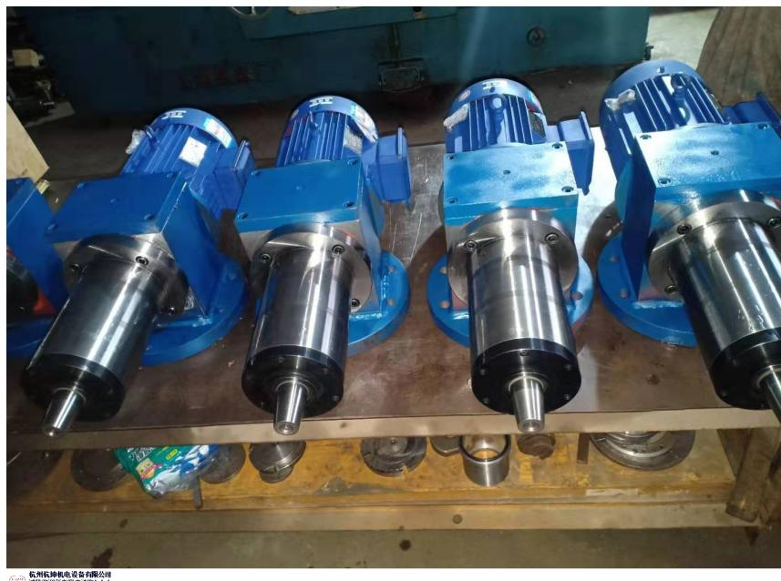
由于当前电主轴主要采用的是交流高频电动机，故也称为“高频主轴”(High Frequency Spindle)。由于没有中间传动环节，有时又称它为“直接传动主轴”(Direct Drive Spindle)。电主轴具有结构紧凑、重量轻、惯性小、振动小、噪声低、响应快等优点，而且转速高、功率大，简化机床设计，易于实现主轴定位，是高速主轴单元中的一种理想结构！帝益电主轴外观图 电主轴轴承采用高速轴承技术，耐磨耐热，寿命是传统轴承的几倍！产品特性 高转速、高精度、低噪音、内圈带锁口的结构更适合喷雾润滑开封正规导轨磨头厂商质行万里，贵在品位！
